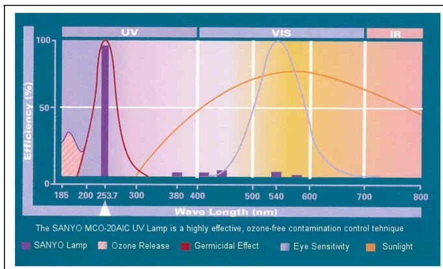
funzionamento ciclizzato durante l'incubazione di cellule. La particolare lampada U.V. utilizzata genera una emissione di luce con banda molto vicina a 253,7 nm che è tossica per i microorganismi ma non genera ozono che viene invece prodotto a 185 nm. La lampada U.V. è posizionata all'interno dell'incubatore ma
